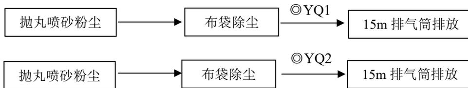
图 3-2 废气处理工艺流程图 (◎有组织废气监测点位)
